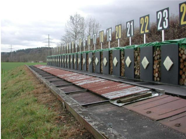
Bereits seit mehr als 5 Jahren mit Kugelfangkästen ausgerüstete, viel benützte Anlage. Sichtbar sind die Abdeckplatten und die umgebenden Rundhölzer. Der Preis für Kugelfangkästen beträgt aktuell inklusive Montage ca. Fr. 3'000 pro Scheibe bzw. Kasten.
