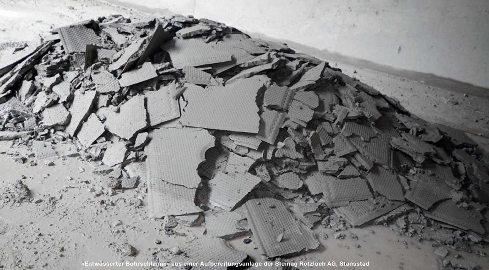
«Entwässerter Bohrschlamm» aus einer Aufbereitungsanlage der Steinag Rotzloch AG, Stansstad
