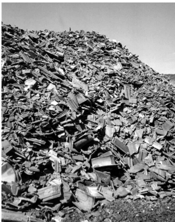
Abb. 6 > Dachziegelbruch – ausschliesslich Dachziegel.
