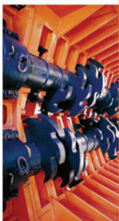
Figure 12: Broyeur pour déchets encombrants incinérables
